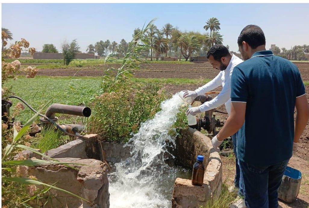
شكل (١٢) يبين طريقة أخذ عينة مياه مأخوذة من طلمبة رفع ممثلة لترعة الصفيحة.
