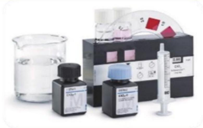
**جهاز قياس الكلور الحر**
